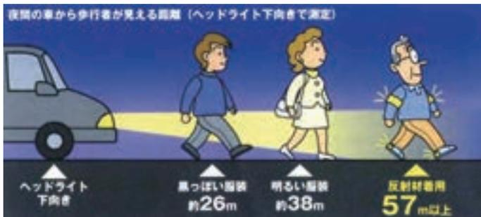
このテストではJPマークの付いた製品によるもので、面積2.5cm<sup>2</sup>かつ117mcd/lux以上の反射材を使用しています。
