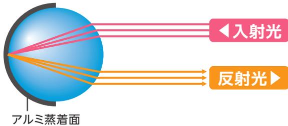
入射光は、ガラスビーズの表面を通過するときに屈折し、裏側のアルミ蒸着面で反射して、再び表面を通過する時は屈折して光源に戻ります。
