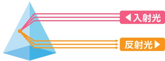
表面の入射光は、プリズムの裏側の面で次々に反射して、表面から光源に戻ります。
