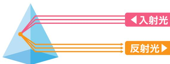
表面の入射光は、プリズムの裏側の面で次々に反射して、表面から光源に戻ります。
